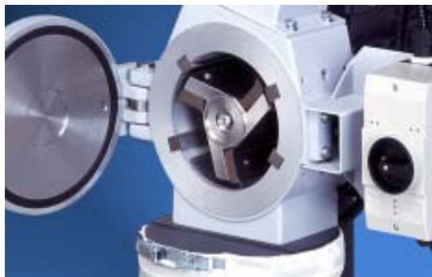
Вид размольной камеры SM 100 (параллельный секционный ротор с 3 ножами и 4 неподвижными отрезными брусками в размольной камере)
