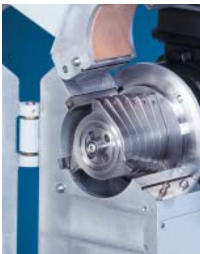
Вид размольной камеры SM 2000 (универсальный 6-дисковый ротор для высокопроизводительного измельчения по касательной)
